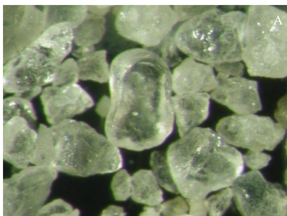
Fig. 7. (A, B) Granule rotunjite și foarte rotunjite
