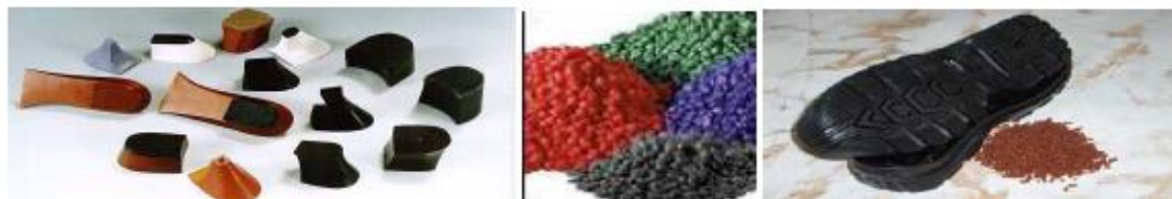
Fig. 5. Materiale polimerice pe baza de cauciuc EPDM reticulat/Materiale polimerice cu proprietăți performante/Talpi din PVC și TR pentru încălțăminte de uz general și de protecție realizate din aliaje polimerice cu deșeurilor elastomerice
