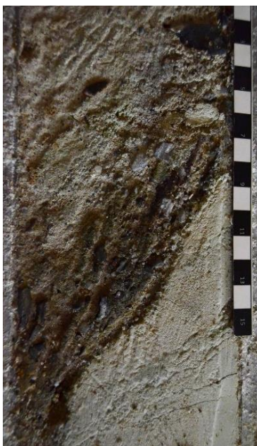
Fig. 2. Detaliu din carota mecanica Videle. Se observă discordanța majoră dintre calcarul de vârstă Cretacic inferior și microconglomeratul polimictic de vârstă Sarmațiană.
