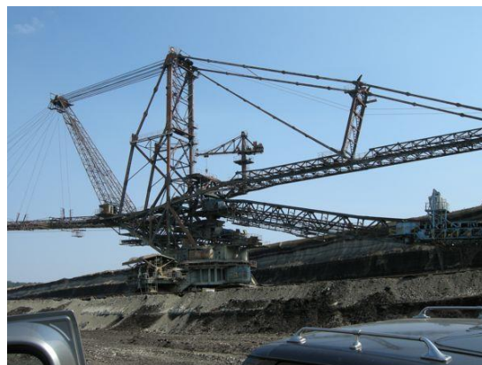
Fig. 3. Mașina de haldat din cariera Husnicioara
